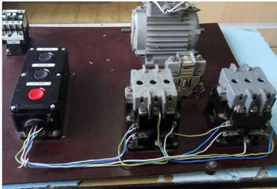
13. Делаем перемычку между катушек K1 и K2 магнитных пускателе KM1 и KM2.
