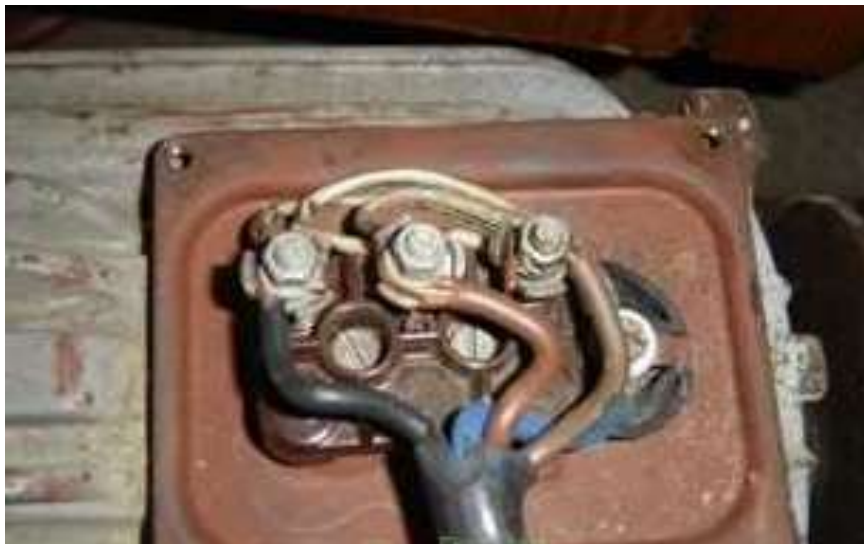
Рисунок 2 – Соединение обмоток двигателя по схеме «звезда»
