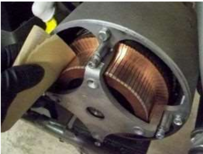
Рисунок 15- Очистка коллектора губкой
