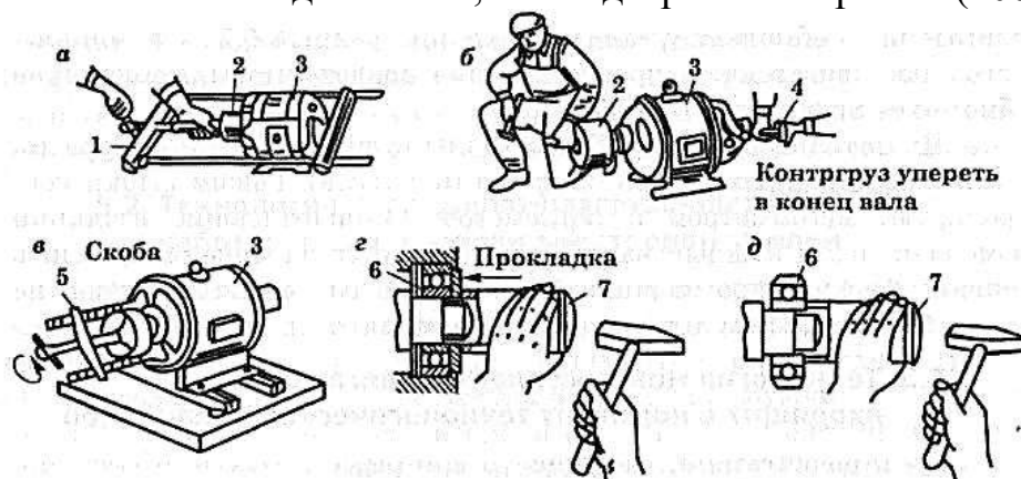
а — винтовым приспособлением; б — молотком с применением контргруза; в — снятие шкива съемником; г — посадка подшипника в гнездо; д — посадка подшипника на вал; 1 — винтовое приспособление; 2 — шкив; 3 — электродвигатель; 4 — контргруз; 5 — съемник; 6 — подшипник; 7 — труба с заглушкой
